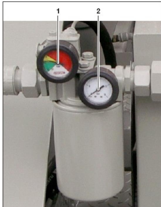
Рис. 7.27 Индикация загрязнения фильтров
