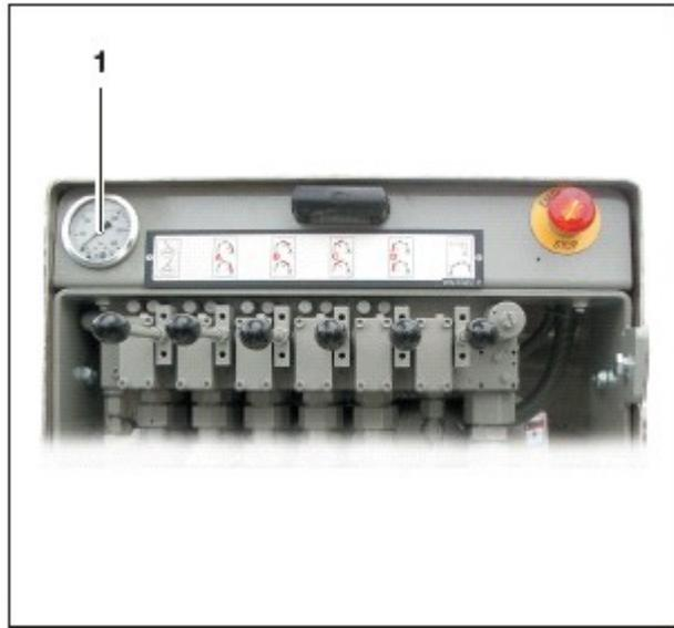
Рис. 7.26 Блок управления распределительной мачтой
