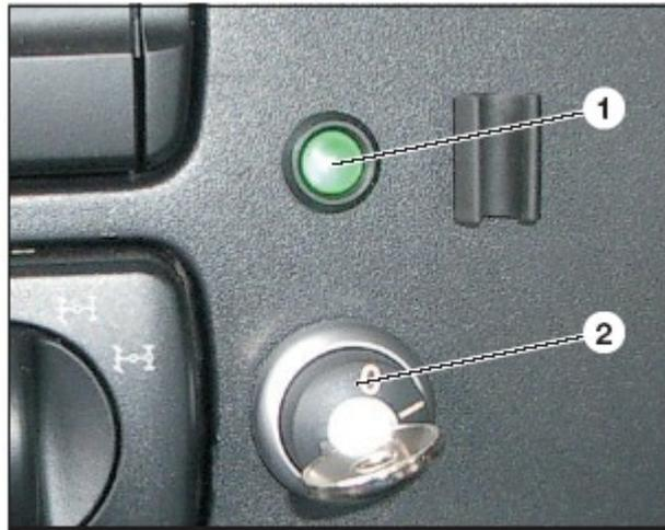
Рис. 7.3 Переключение раздаточной коробки
